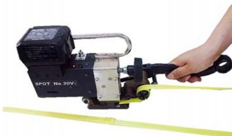
⑤引き締めハンドルを手前に倒しバンドから本機を外し作業完了
