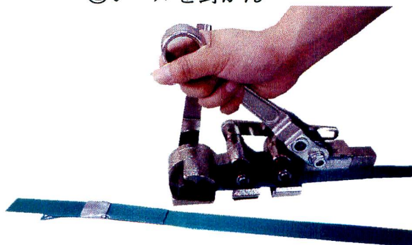
⑥カッターレバーを手前に倒しながら引き締め機を取り外し、結束完了。バンドは引き締めレバーを上写真のように前方に倒し取り外します
