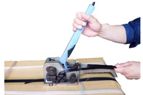
③レバーを前後に操作しバンドを引き締めます
