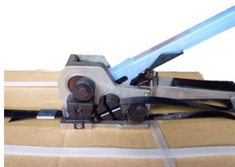
②シールをセットしたバンドを周回させドラムにセットします
