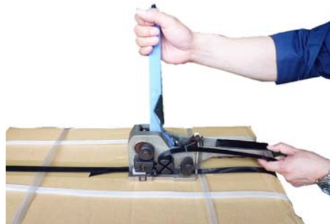
⑤レバーを操作するとシールがプレスされ封かんされていきます
