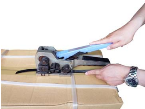
①レバーを押さえバンド先端をセットします
