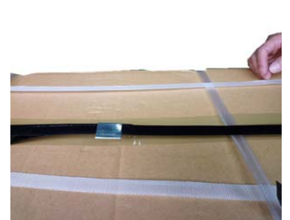
⑥レバーを元に戻すとバンドが切断され結束が終了です
