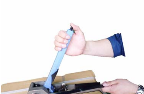
④レバー先端のボタンを押すと封かん作業に切り替わります
