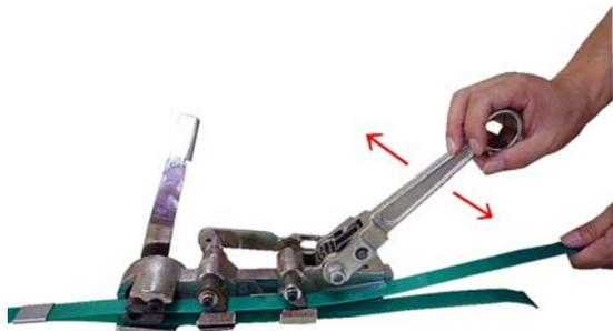
③引き締めレバーを前後に操作し引き締め
