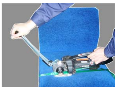
⑥引締レバーを前方に操作すると
