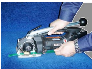
②引締レバーを押しながらバンド先端をセットします
