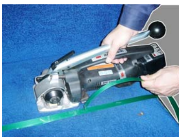
⑦溶着&バンドの切断 →作業完了
