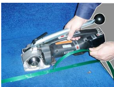
⑦溶着&バンドの切断 →作業完了
