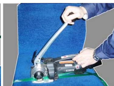
④引締レバーを操作し、バンドを引き締めます
