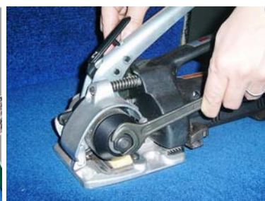
★トルクリミッター 引締力のMAX値調整
