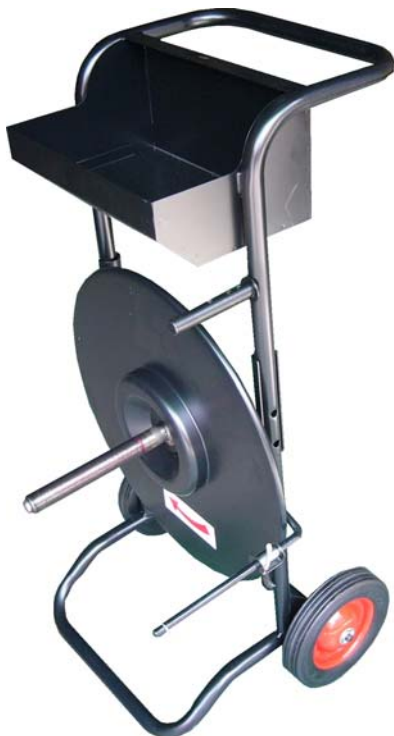
外側ドラムを外した状態 (外側ドラムは強化樹脂製、 内側ドラムは鉄製です)
