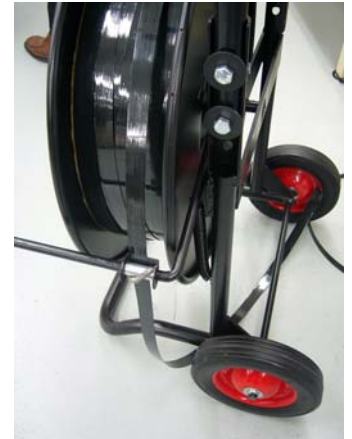
レバー操作により巻単に ブレーキ解除されます バンド取り出し口ホルダーに バンドを通して御使用下さい
