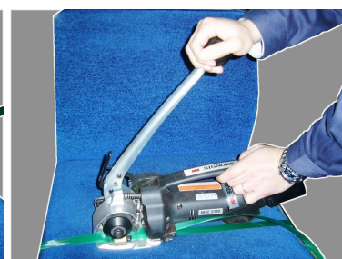
④引締レバーを操作し、 バンドを引き締めます
