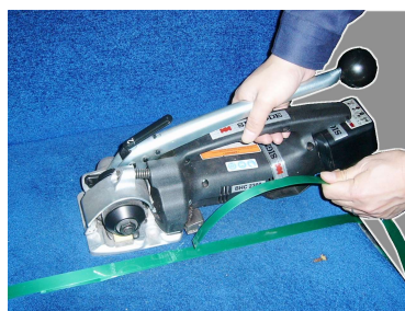
⑦溶着&バンドの切断 →作業完了
