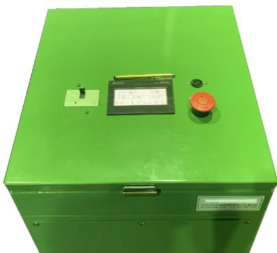
液晶タッチパネルで操作設定
