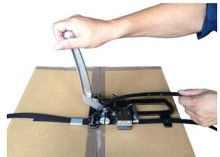
引き締めレバーを操作し引き締めます
