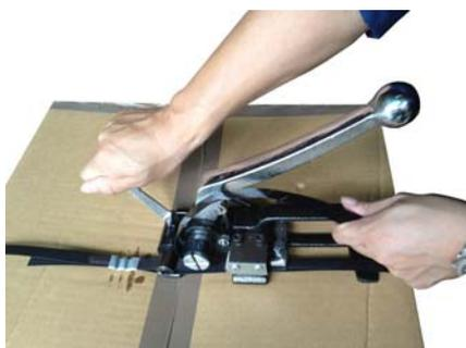
カッターレバーを操作しバンドを切断します
