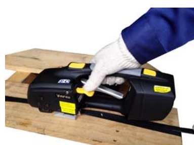
引き締めボタンで引き締め・溶着開始ボタンで溶着&カット
