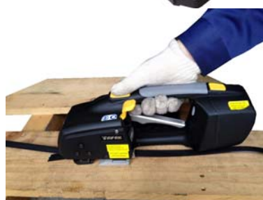
引き締めボタンで引き締め・溶着開始ボタンで溶着&カット
