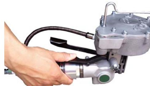
③シーラーレバーで 封かんすると同時に 余剰帯鉄切断
