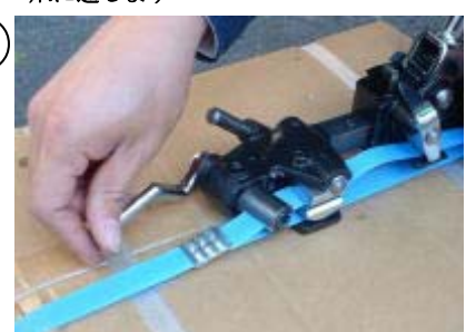
先端側レバーを操作し、バンドを 切断してください
