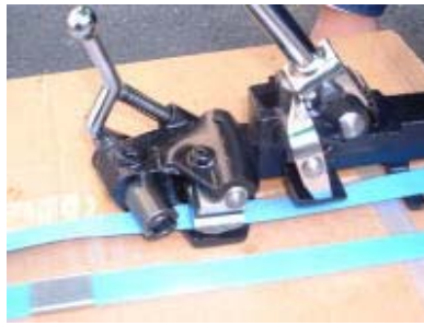
先端側ハンドルを操作し先端側の バンドを爪下側に通します
