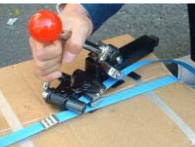
ハンドルを握るとバンドのロックが 解放されますので引締め機を取り 外してください
