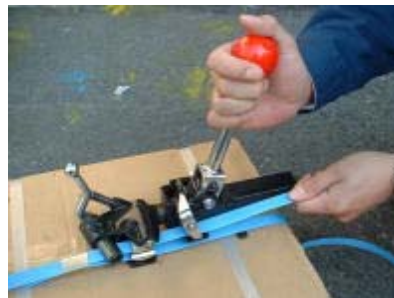
引締め用ハンドルを操作して引き締め 増し締めする時はハンドルを前に 倒して前進させます
