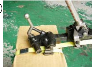
比較的結束部の幅が狭い場合にも結束が 可能です また、曲面部においても使用が可能です (写真の場合は14cm幅です)
