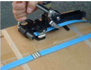
これでバンドの結束が終了します 梱包物が丸物でも結束が可能です
