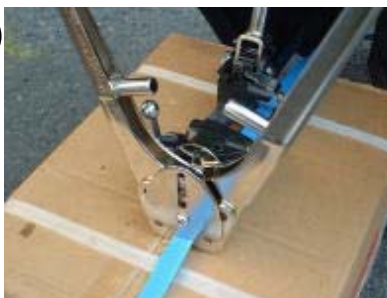
引締めが完了しましたらバンドが シールを通っていることを確認後 封緘してください
