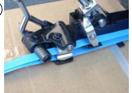
引き締め用ハンドルを前に倒して 片方のバンドをカッター、溝、固定 爪に通します
